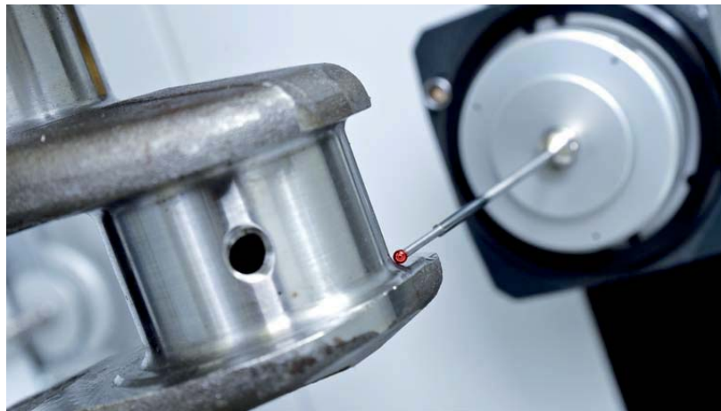
Abb. 3a: Messung des Übergangsradius am axialen Lagersitz
