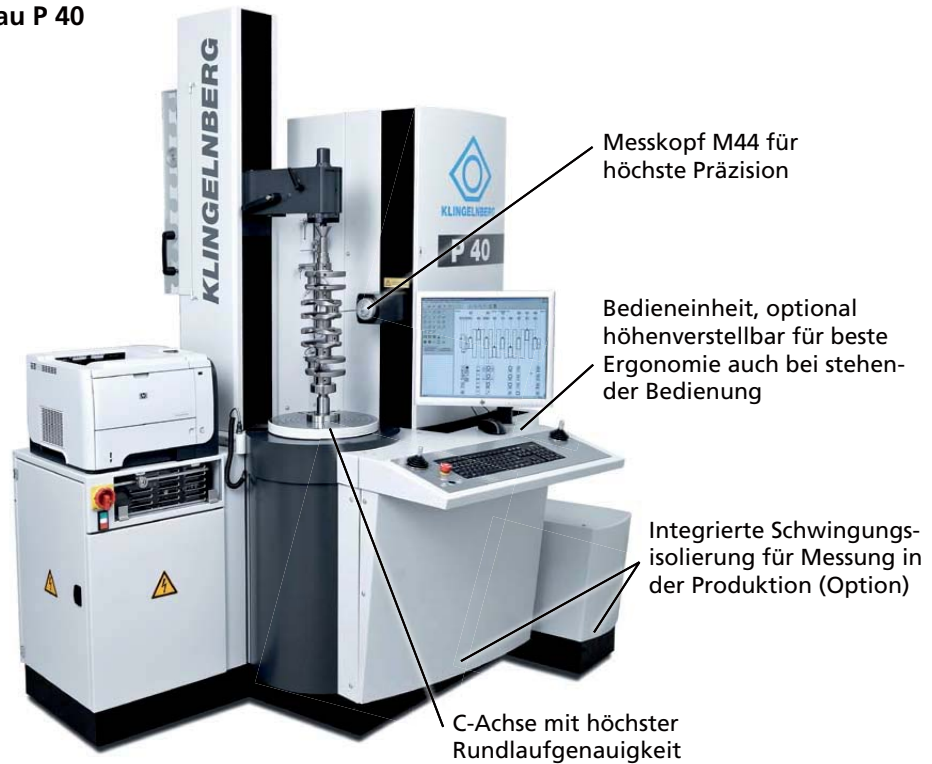
Abb. 1: Präzisionsmesszentren wie die P 40 erlauben die Messung der gesamten Welle mit allen zu messenden Parametern.
