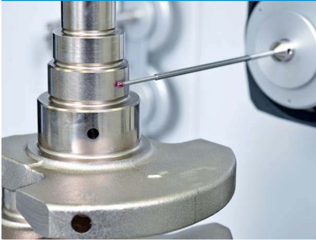
Abb. 2a: Messung der Lagersitze (Maß, Form und Lage)
