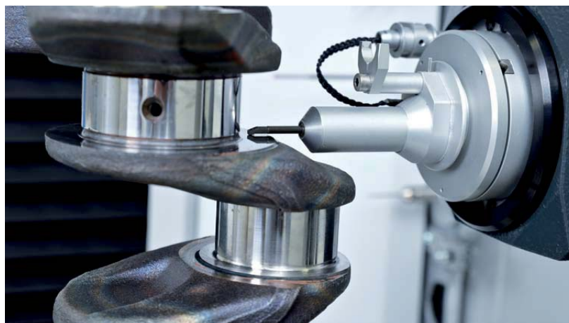
Abb. 3b: Rauheitsmessung an der axialen Lager-Lauffläche
