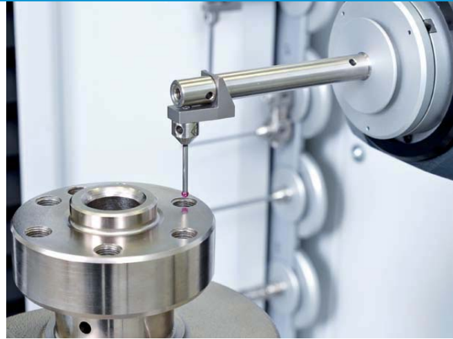
Abb. 2b: Prüfung des Antriebsflansches (Messung von Bohrung und Winkellage); im Hintergrund ist der automatische Tasterwechsler zu sehen.
