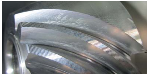
Abb. 2: Kratzer in der Oberfläche beim Fräsen der Ritzel
